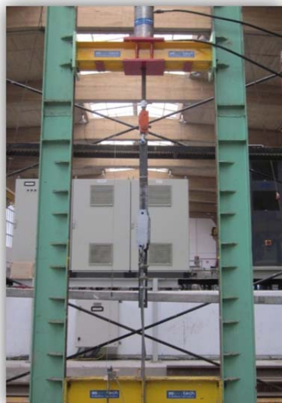
Ensayos de certificación de los disipadores 3S-DPL en colaboración con la Universidad Cantabria
