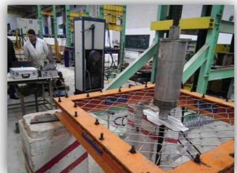
Sistema para la realización de ensayos de carga concentrada sobre membranas.
